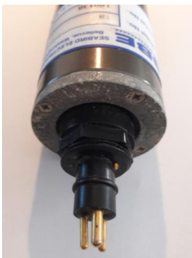
Slika 6: Cinkova anoda na ohišju sonde
