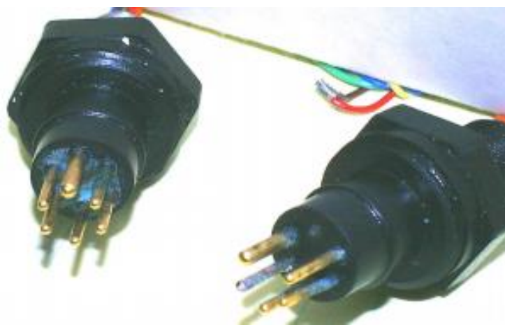
Slika 7: Oksidirane priključne sponke
