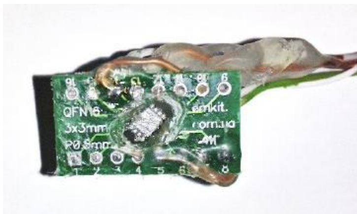
Slika 65: Prilagoditev senzorja ADT7420
